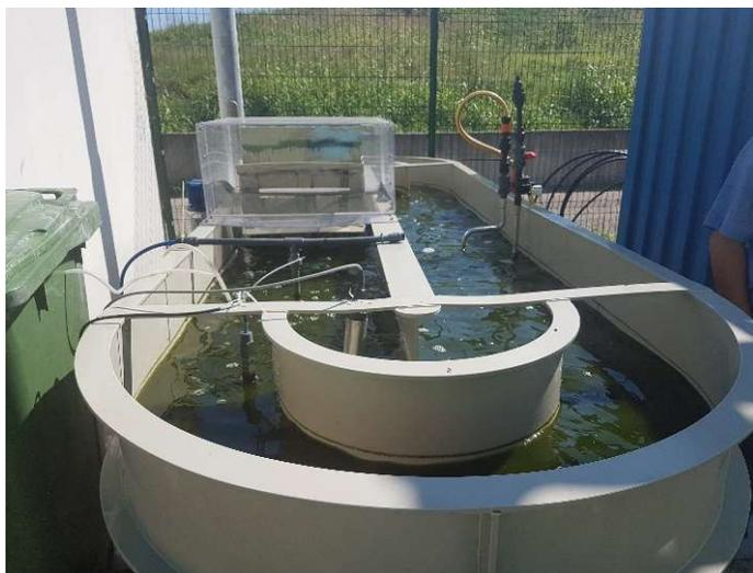
Prototipo di Minibiodigestore a umido
