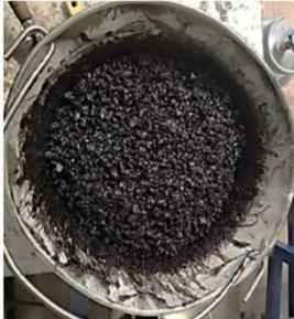
Mix con 4% mps sul totale di bitume
